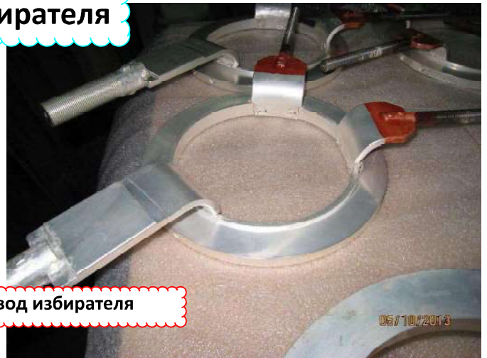
После механической обработки и наращивания меди
